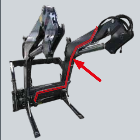
Τοποθέτηση σωλήνων για REAL3 rd
